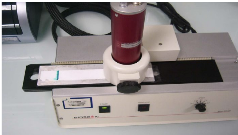
Figure 1. Lecture de la plaque de chromatographie.
